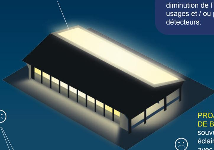
La présence d'éléments vitrés en galerie ou nef de toiture, ou d'ouvertures latérales (larges ou à travers des persiennes) laisse s'échapper une grande quantité de lumière intérieure, créant un halo dans l'environnement nocturne extérieur.
