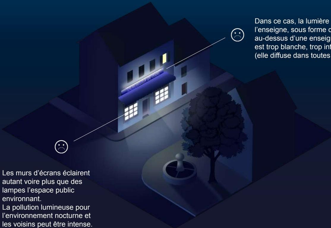
Dans ce cas, la lumière des lampes éclairant l'enseigne, sous forme d'une barre LED continue au-dessus d'une enseigne en bâche imprimée, est trop blanche, trop intense et mal orientée (elle diffuse dans toutes les directions).
