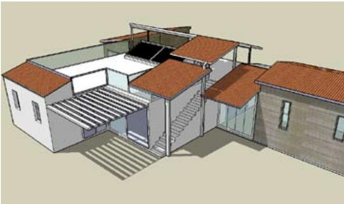
*Habitation composée de multiples volumes comme sur le versant rhodanien du Pilat utilisant le bois pour ses qualités d'isolation dans les chambres et d'autres matériaux pour leur inertie dans les pièces de jour. Capteurs solaires au sud et terrasse.*
